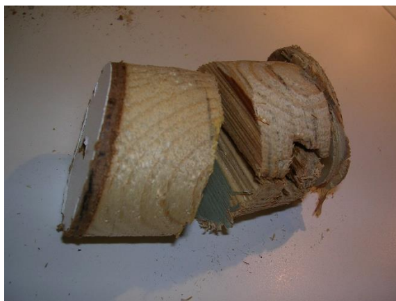
Borrkärnor mellan kök och kafédel. T.h. syns att de spontade brädornas not ligger mot varandra.
