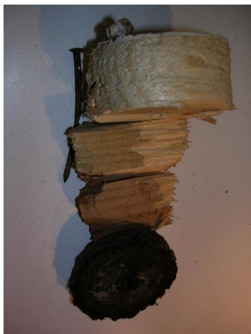
Borrkärnor mellan kök och kafédel. T.h. syns att de spontade brädornas not ligger mot varandra.
